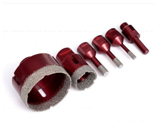
Obr. 1: Anatomie vakuově pájené diamantové korunky KRAFT&DELE KD11219 s vnitřním voskem a závitem M14
