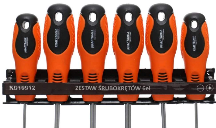
Obr. 1: Zámečnické šroubováky KRAFT&DELE KD10912 s šestihranným profilem pro pomocný klíč
