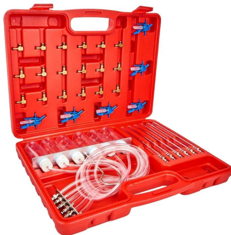
Obr. 1: Uspořádání diagnostických prvků testeru tlaku Common Rail Kraft&Dele KD10698
